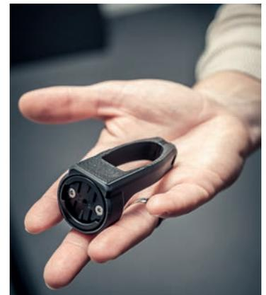
Typisches 4Frames-Zubehörteil, direkt aus dem 3D-Drucker.
