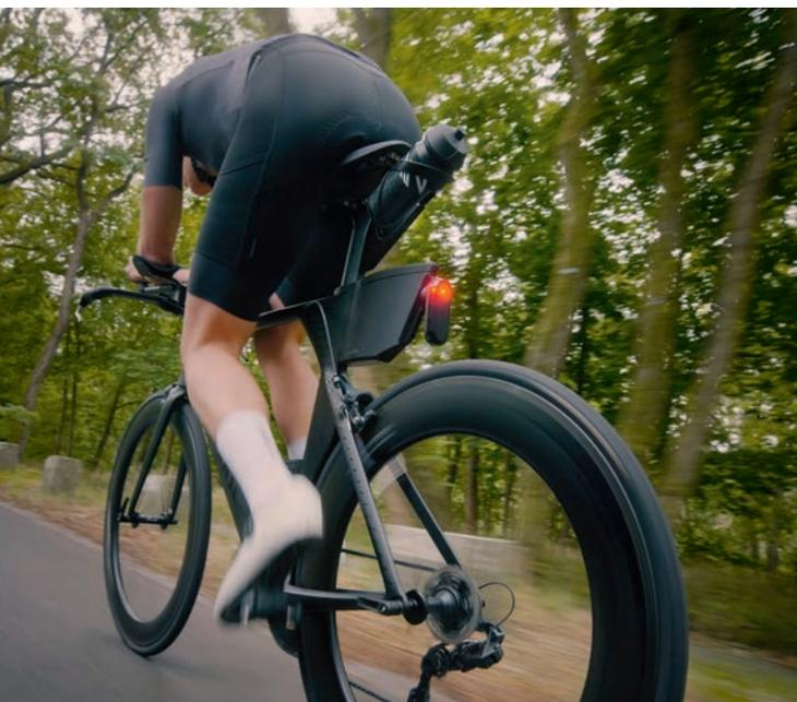
4Frames-Produkt im Triathlon-Einsatz: An der Sattelstütze ist die Toolbox AeroRear mit magnetischem Deckel befestigt. Sie bietet Stauraum für Ersatzteile und Werkzeuge.
