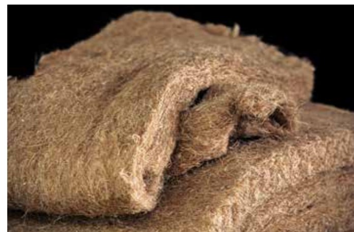
Hanf wird als Dämmmaterial genutzt.
