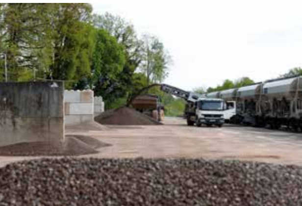
Knapp 3.500 Tonnen Kies werden hier in kürzester Zeit abgeladen und für den Transport zum Betonwerk bereitgestellt.
