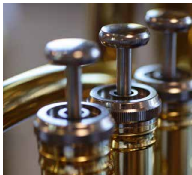
Präzise Ventile verändern die Rohrlänge von Blasinstrumenten
