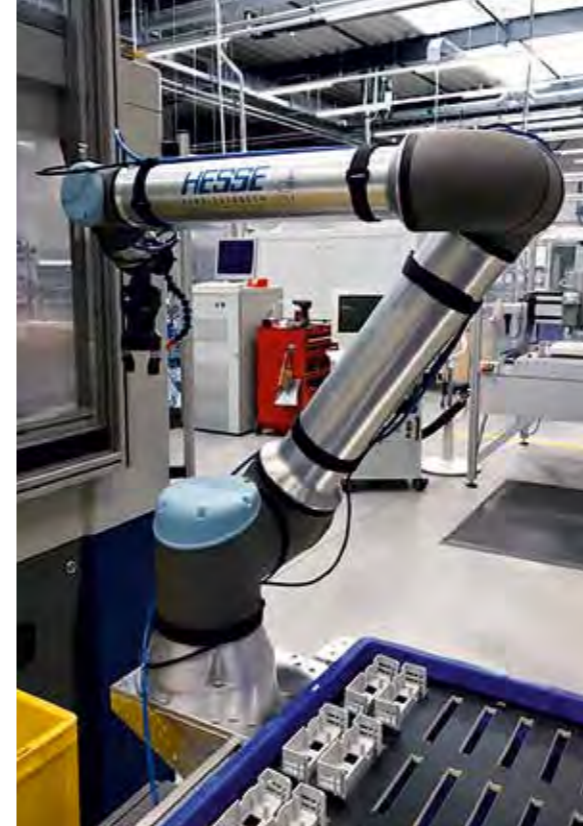
Die Cobots von Universal Robots finden vielfältige Anwendungen. Das Bild zeigt eine Lösung zum Maschinenbeladen einer CNC-Fräse.
